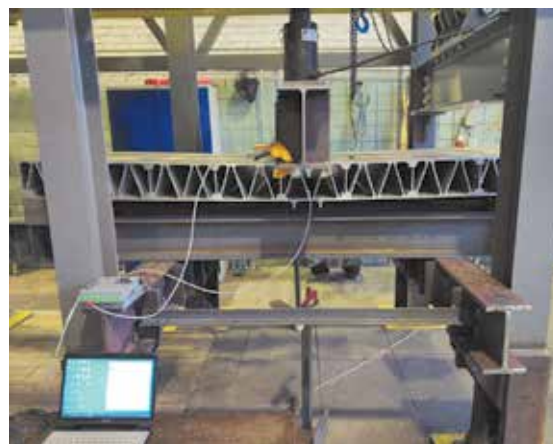
Рис. 5. Контроль параметров нагружения при испытании образца
