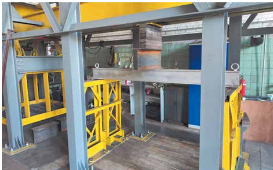
Рис. 1. Стенд для испытаний сварных модельных образцов коробчатого сечения на сопротивление усталости
