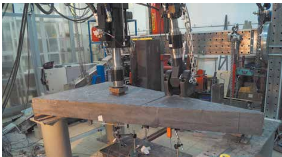
Рис. 3. Проведение статических испытаний полноразмерных образцов из сверхпрочного фибробетона
