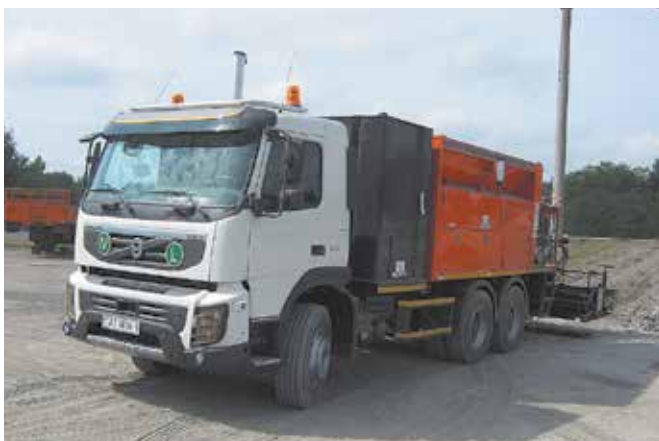
Рис. 7. Смеситель-укладчик Bergkamp M310, РУП «Бреставтодор»
