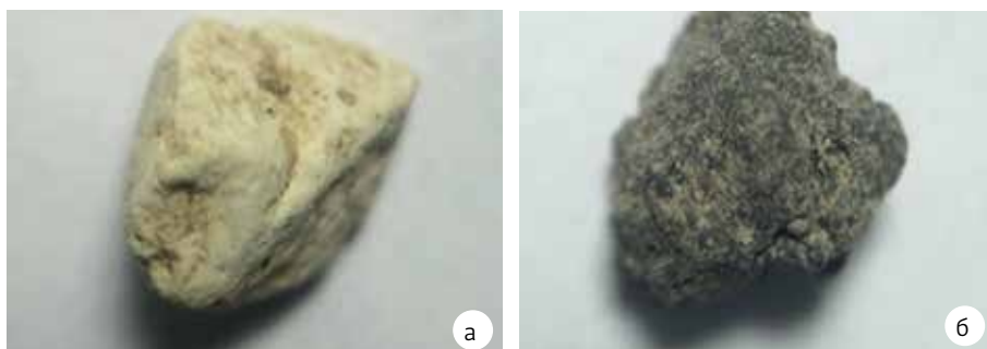
Рис. 4. Микрофотографии (30-кратное увеличение) природного песка (а) и песка из дробленого бетона (б)
