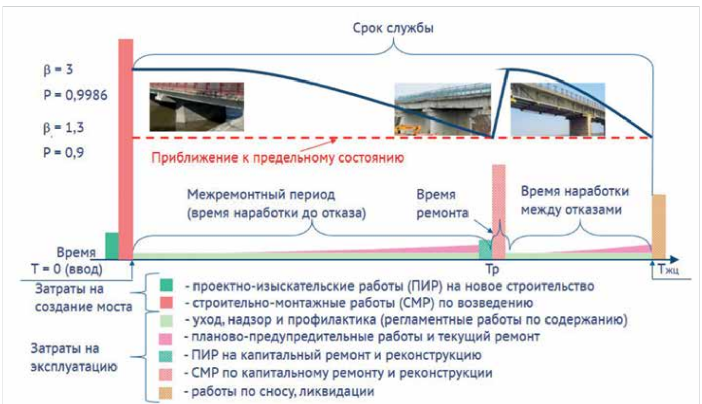
Рис. 3. Диаграмма изменения индекса надежности и основные работы на протяжении жизненного цикла мостового сооружения
