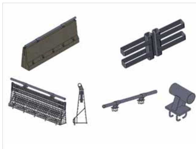
Рис. 16. Разработанная конструкция парапетного ограждения ООО «ЖБИ-5»
