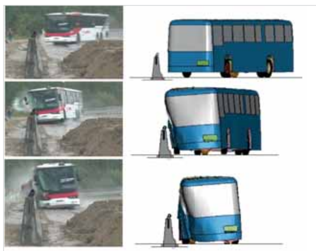
Рис. 18. Кинограммы натурных и виртуальных испытаний парапетного ограждения производства ООО «ЖБИ-5»
