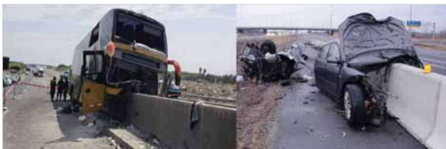
Рис. 10. Наезд ТС на начальный (конечный) участок парашетного ограждения
