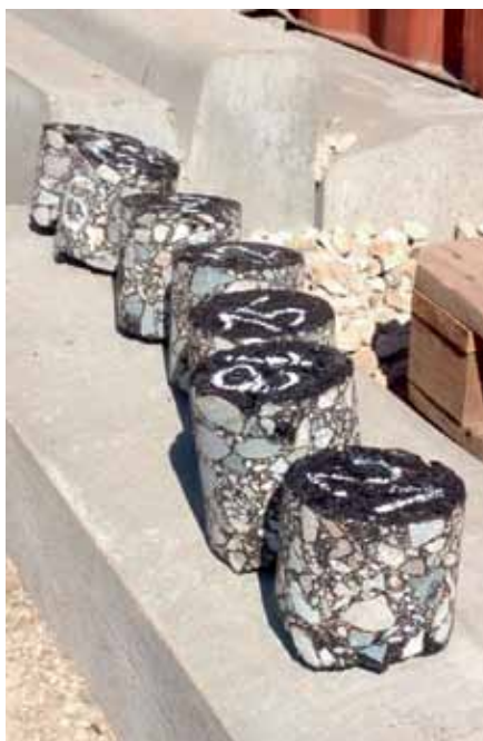
Рис. 1. Структура кернов и поверхности асфальтобетонной смеси SP-37
