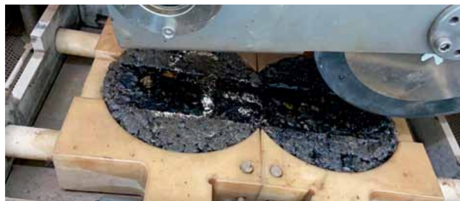
Рис. 4. Испытание верхнего слоя покрытия из ЩМА-19
