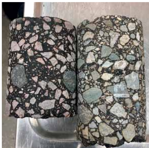
Рис. 3. Сравнение структуры асфальтобетонов по кернам (слева – крупнозернистый плотный тип А, справа – SP-37)
