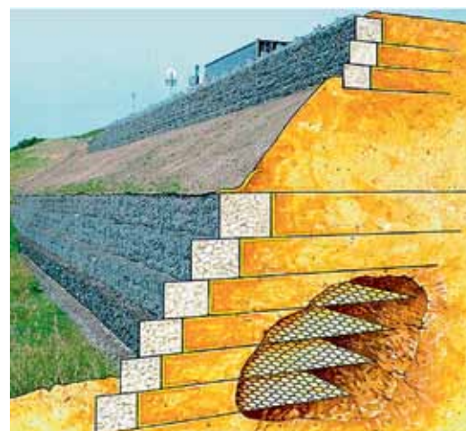
Армогрунтовая система «Террамеш®»
