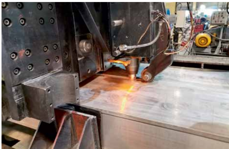
Сварка методом трения с перемешиванием на предприятии «ЗАО Сеспель» в городе Чебоксары
