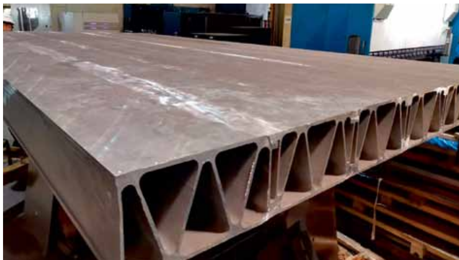
С мая 2020 года на предприятии КРАМЗ (Красноярск) освоена технология изготовления ортотропной плиты из панелей, свариваемых между собой методом трения с перемешиванием
