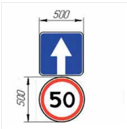
Рис. 3. Габаритные размеры знаков уменьшенного размера в населенных пунктах на улицах и дорогах с одной полосой для движения в каждом направлении по ГОСТ Р 52289-2019
