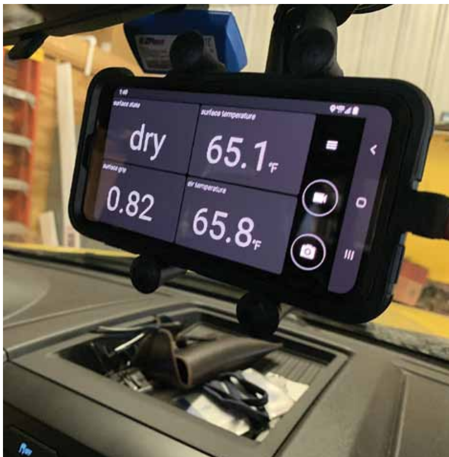
Датчик и платформа сбора данных передают информацию об изменениях температуры дорожного покрытия, о коэффициенте сцепления и влажности дороги, а также определяют участки дороги, где необходимы применение реагентов, очистка или проведение комплекса работ
