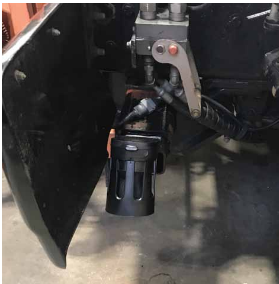
Мобильный детектор MD30 специально разработан для снегоочистителей, чтобы точно собирать и передавать данные о состоянии дорожного покрытия по маршруту следования и между дорожными метеостанциями
