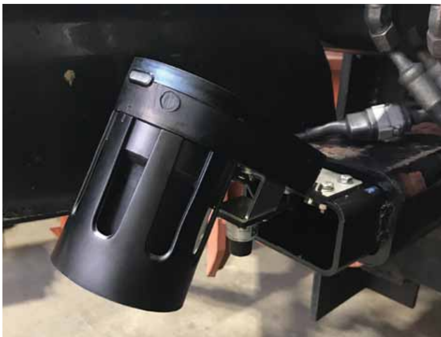
Детектор Vaisala MD30 – мобильный датчик, который измеряет все ключевые параметры дорожного полотна и погоды, необходимые для обеспечения более точного принятия решений по содержанию дорог и использованию оптимальных концентраций противогололедных реагентов
