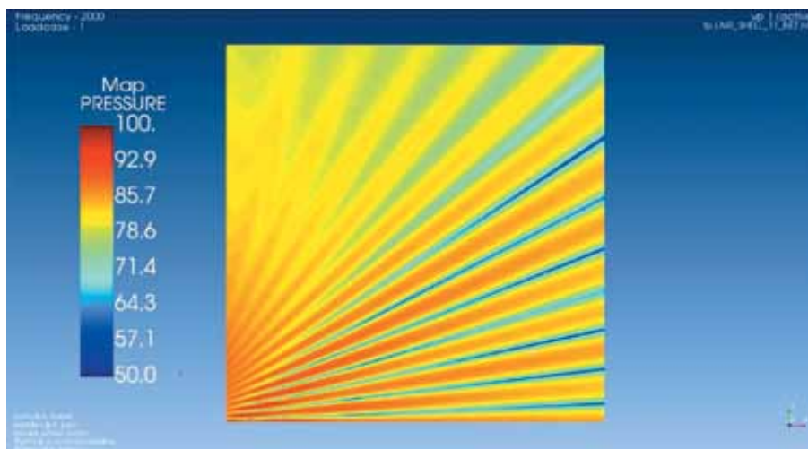
Рис. 6. Распределение уровня звука (дБА) в конечно-элементной области КЭ модели для третьоктавной частоты, равной 2000 Гц, полученное для варианта до установки АЭ
