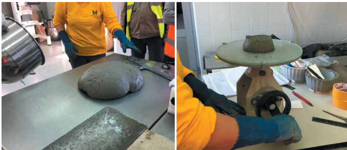
Рис. 2. Тиксотропный состав Ductal® в состоянии смеси в процессе работ в московской лаборатории ЛафаржХолсим
