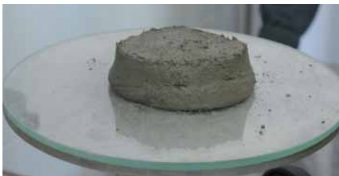
Рис. 2. Самоуплотняющийся и тиксотропный составы Ductal® в состоянии смеси в процессе работ в московской лаборатории ЛафаржХолсим
