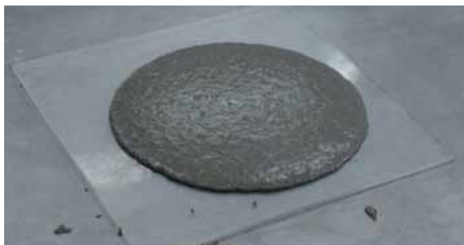
Рис. 2. Самоуплотняющийся и тиксотропный составы Ductal® в состоянии смеси в процессе работ в московской лаборатории ЛафаржХолсим
