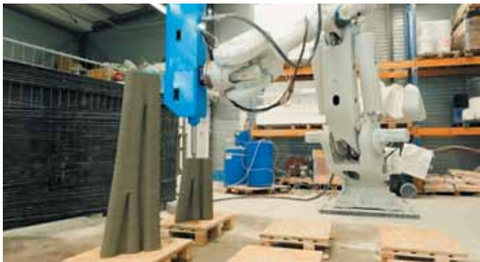
Рис. 15. 3D-печать Ductal® для геометрически сложных конструкций
