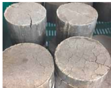
Фото 4. Образцы укрепленного грунта с неправильно выбранными типами вяжущих и при передозировке вяжущих
