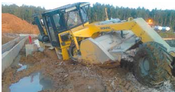
Фото 1. Увязнувший ресайклер на участке с переувлажнённым грунтом
