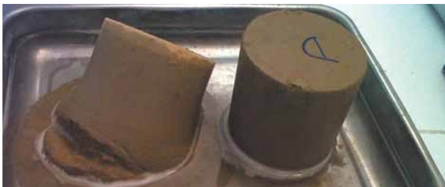
Фото 3. Испытание на водостойкость: укрепленные различными вяжущими грунты
