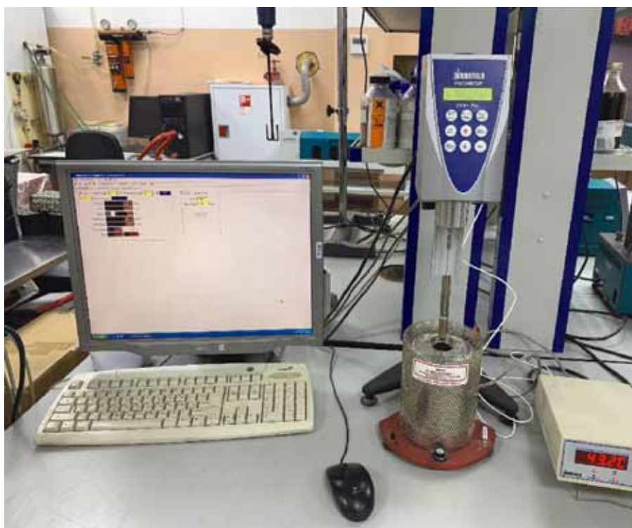
Рис. 2. Вискозиметр Брукфильда для измерения вязкости битума
