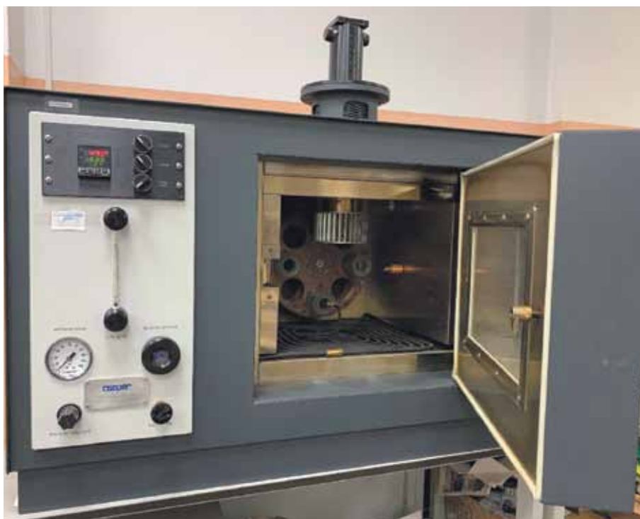
Рис. 1. Печь RTFO для проведения старения битумных вяжущих
