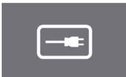
Рис. 4. Горизонтальная дорожная разметка 1.24.5 по ГОСТ Р 51256-2018, геометрические размеры приведены в приложении Б (обязательном) ГОСТ Р 51256-2018
