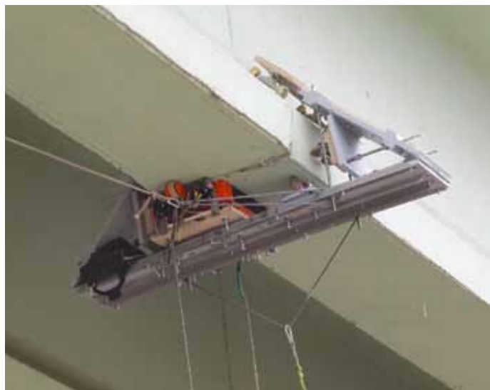
Рис. 10. Неразрушающий контроль преднапряженных балок пролетных строений МС при помощи магнитного дефектоскопа «Интрос»
