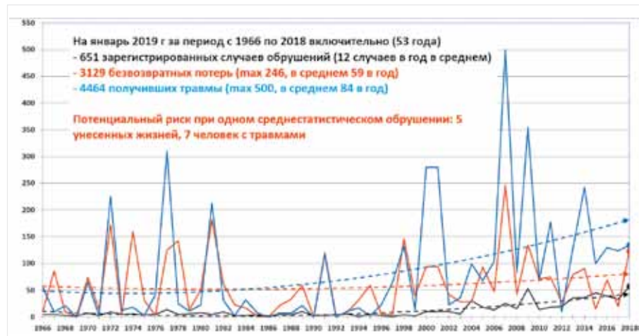
Рис. 2. Мировая статистика и тренды роста критических отказов автомобильных и пешеходных МС и их последствий для жизни и здоровья человека за 1966–2018 годы (на январь 2019)
