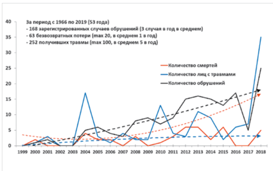
Рис. 6. Статистика за последние 20 лет и тренды роста критических отказов российских автомобильных и пешеходных МС и их последствий для жизни и здоровья человека
