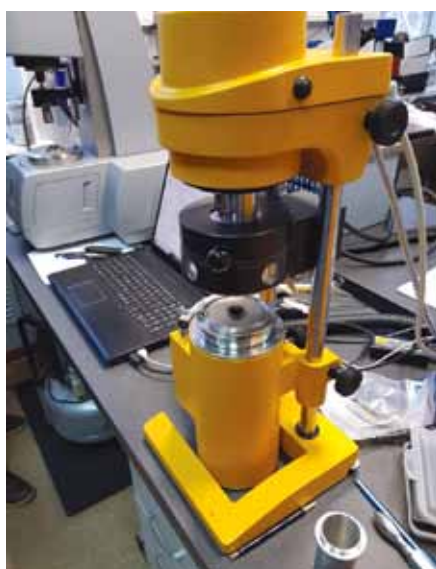
Динамический сдвиговый реометр RHEOTEST RN 5.3 на сравнительных испытаниях в лаборатории НИИ ТСК, Москва. Модель RN 5.3 в базовой комплектации для DSR-испытаний по ПНСТ-2016 (ГОСТ Р-2019)
