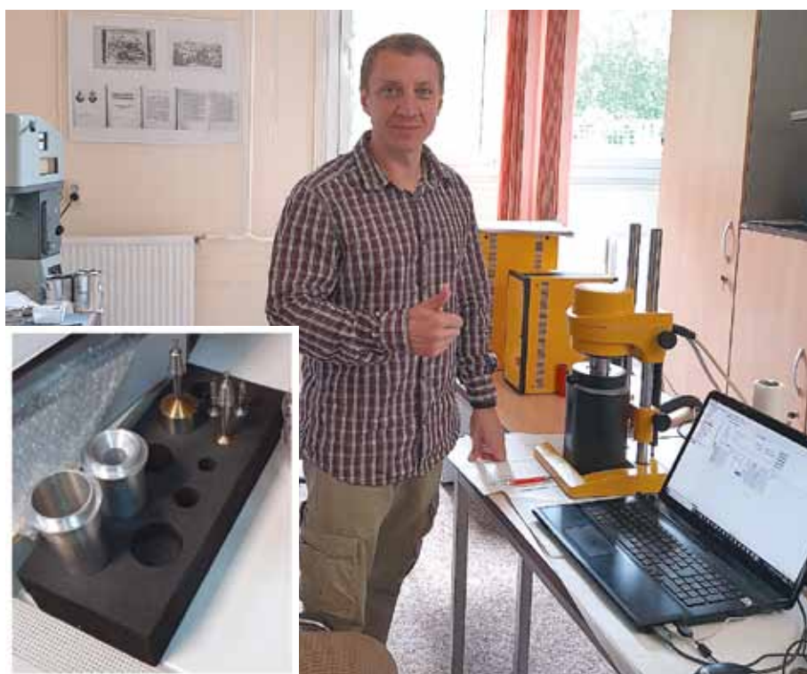
Испытания битумных вяжущих по ГОСТ 33137-2014 на реометре RHEOTEST RN 5.3 (Германия) с участием специалистов лаборатории битумных вяжущих НИИ ТСК. Получены отличные результаты!
