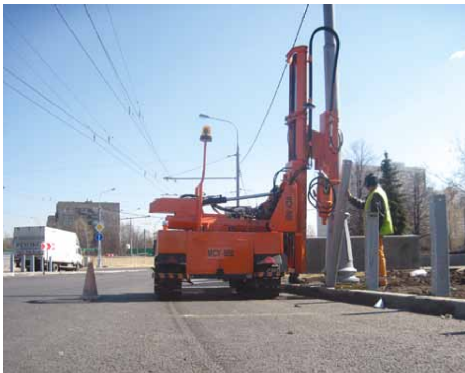
Рис. 2. Установка МСУ-800 (1200) в рабочем положении
