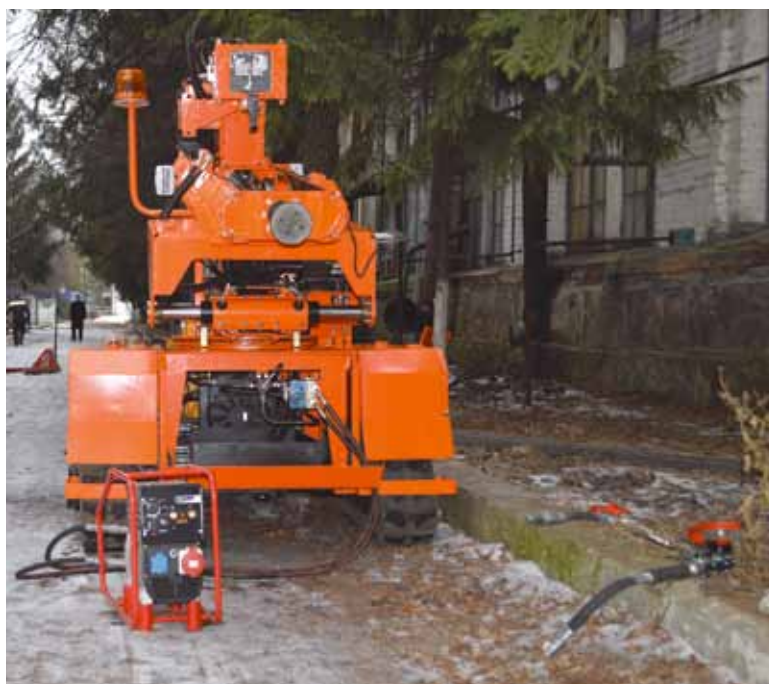
Рис. 7. Гидравлический адаптер для подключения гидравлического инструмента
