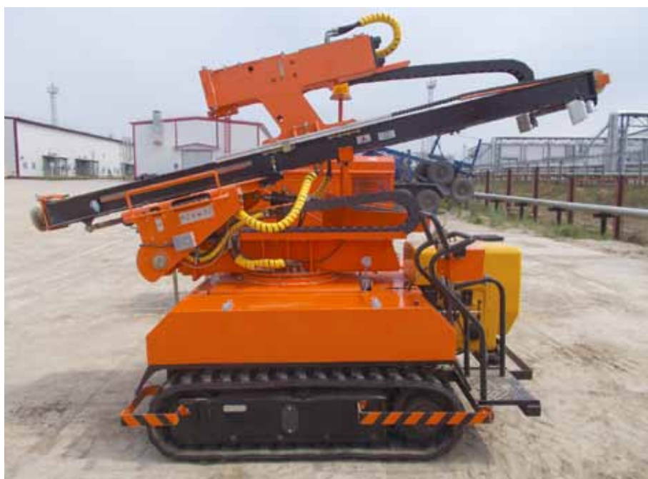
Рис. 1. Установка МСУ-800 (1200) в транспортном положении
