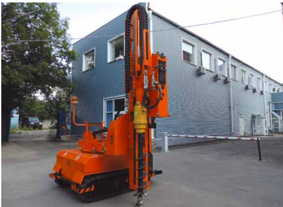
Рис. 4. Установка МСУ-800 (1200) с гидравлическим вращателем и буром
