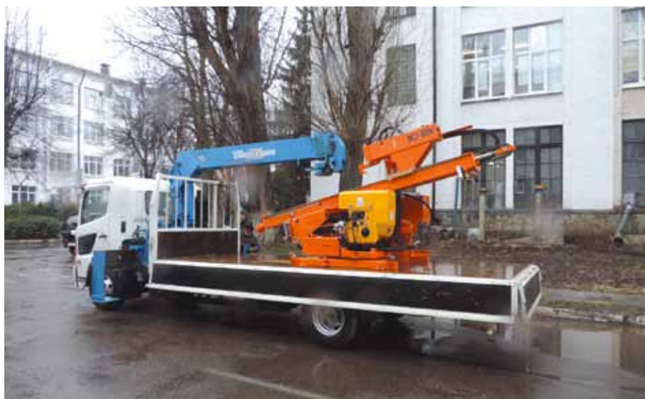
Рис. 3. Установка МСУ-800К (1200К) в транспортном положении
