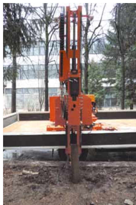
Рис. 5. Установка МСУ-800К (1200К) в рабочем положении
