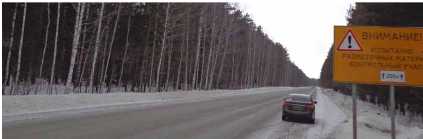
Рис. 3. Контрольные линии через девять месяцев эксплуатации (семь месяцев – для полимерных лент). Автомобильная дорога К-12 Новосибирск – Томск, км 30 (с асфальтобетонным покрытием), находящаяся под управлением ГКУ НСО ТУАД
