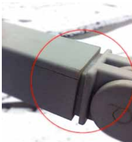
Рис. 20. Неплотное соединение элементов и соединение с натягом, приведшее к появлению трещины в поручне
