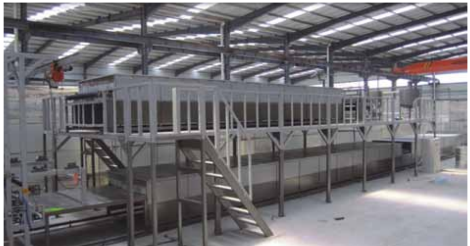
Рис. 12. Линия по производству композитного листа, профильного листа и водоотводных подвесных лотков
