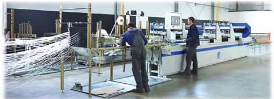
Рис. 11. Две линии пултрузии мощностью 6 и 12 тонн.
