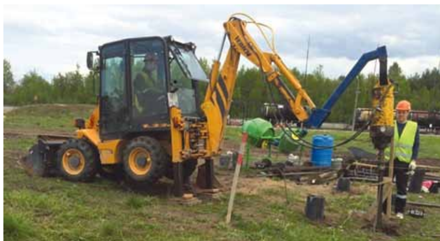
Рис. 1. Миниэкскаватор-погрузчик, оборудованный гидравлическим вращателем
