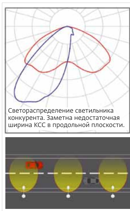
Рис. 2. Светораспределение светильника, не обеспечивающее равномерную заливку дорожного полотна.
