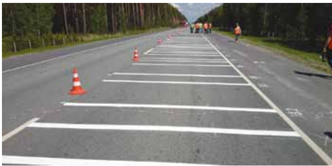
Рис. 10. Контрольные линии добровольных полевых испытаний материалов и изделий для горизонтальной разметки на участке автомобильной дороги Р-254 «Сибирь» с асфальтобетонным покрытием (непосредственно после нанесения)
