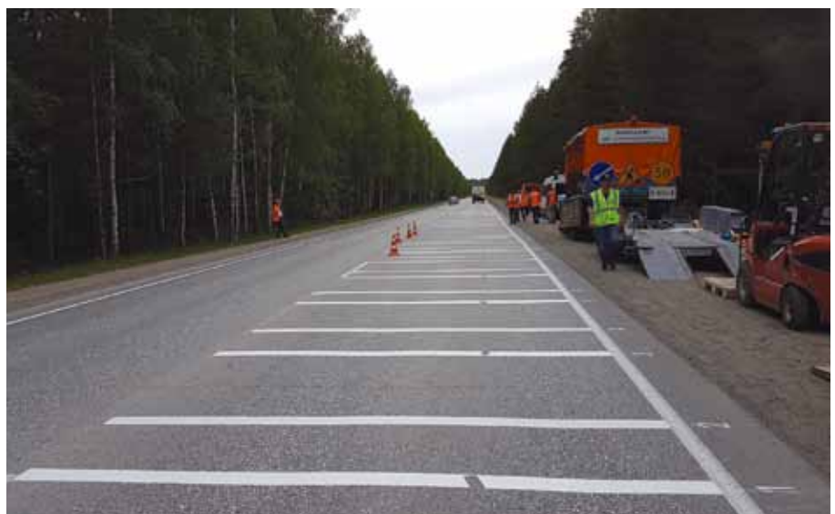
Рис. 6. Внешний вид участка № 3 СПИ 2017–2018 после нанесения контрольных линий (до открытия движения)
