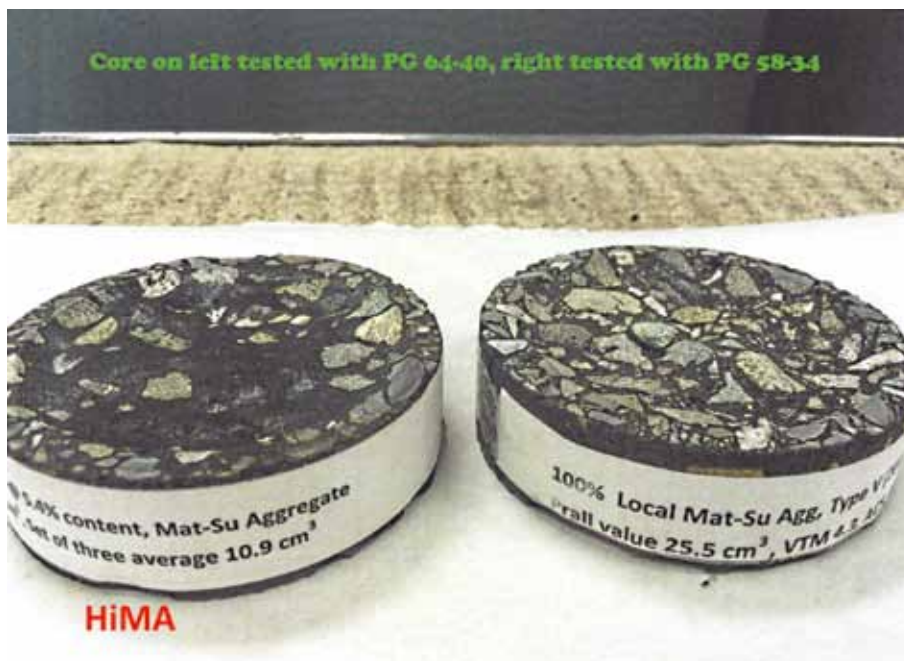
Рис. 1. Сравнение состояния лабораторных образцов, имитирующих керны покрытий, изготовленных с применением коммерческих вяжущих: высокомодифицированного битума (HiMA) и регулярного ПБВ*
