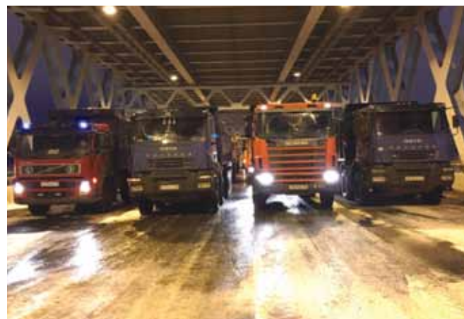
Рис. 2. Испытательная нагрузка на нижнем ярусе ферменного пролетного строения
