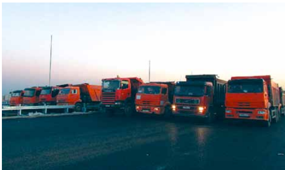
Рис. 4. Испытательная нагрузка в пролете IVc-6 – IVc-7 единого пролетного строения моста в устье реки Большая Нева на подходе к вантовому мосту через Корабельный фарватер
