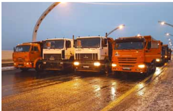
Рис. 1. Испытательная нагрузка на верхнем ярусе ферменного пролетного строения
