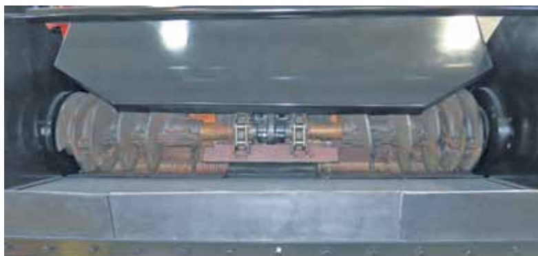
Рис. 1. Трехшаговый шнек в приемном бункере
