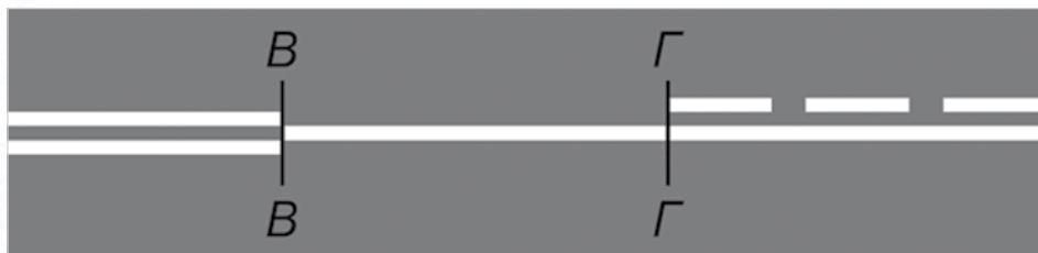
B-B – граница сплошной двойной линии и сплошной одиночной линии; Г-Г – граница сплошной одиночной линии и сочетания сплошной одиночной линии и прерывистой одиночной линии с соотношением длины штриха к расстоянию между штрихами, равным 3:1
