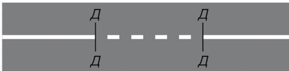
Д-Д – граница сплошной одиночной линии и прерывистой одиночной линии с соотношением штриха к расстоянию между ними 1:1
