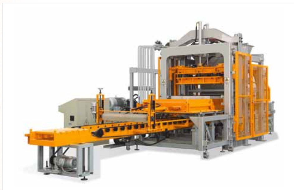
Пресс для производства блоков методом вибропрессования, модель QFT10-15
