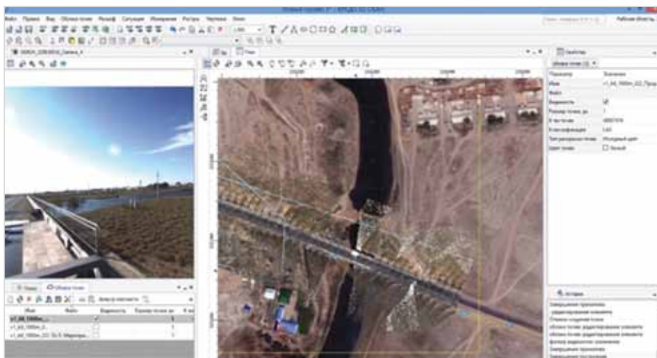
Рис. 3. Работа с облаком точек, веб-картами и фотоматериалами в CREDO 3D СКАН
