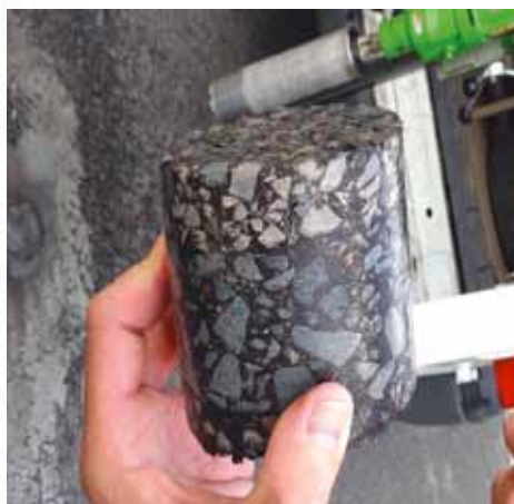
Фото 1. Керн из асфальтобетонного покрытия, устроенного по высокотемпературной технологии на Батайском проезде в Москве в декабре 2011 года:
