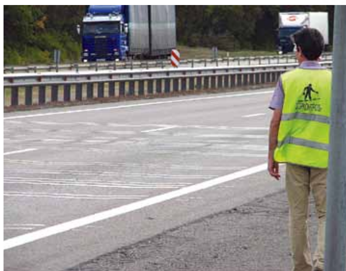
Рис. 2. Внешний вид отдельных контрольных линий на участке сравнительных полевых испытаний материалов для горизонтальной дорожной разметки на участке автомобильной дороги М-4 «Дон» в Воронежской области (СПИ 2014–2015, сентябрь 2015 года)
