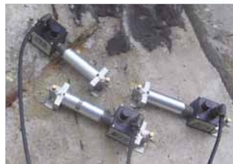
Рис. 9. Датчики Э.ТОЭ.01, установленные на железобетонное пролетное строение
