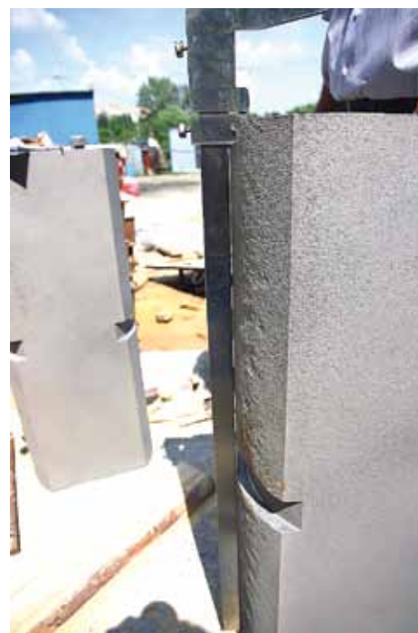
Рис. 9. Очаги коррозии на отпескоструенной поверхности катков
