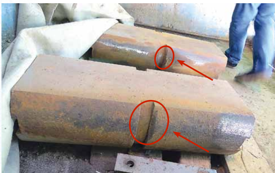
Рис. 11. Смятие кромки паза на катках
