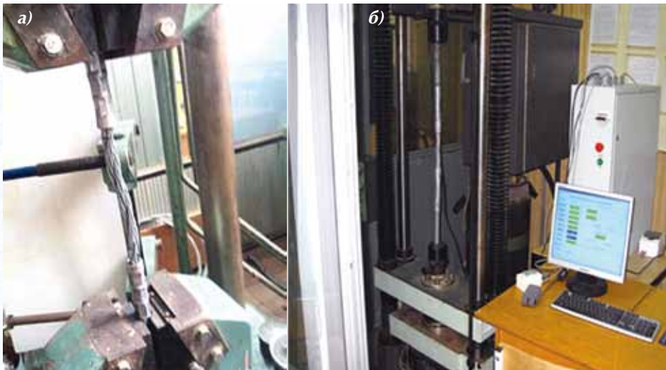
Рис. 3. Испытания тросов на испытательных машинах в лаборатории кафедры строительной механики МАДИ: а) испытания на разрыв при усилии до 30 т; б) испытания на растяжение с получением характеристик деформирования
