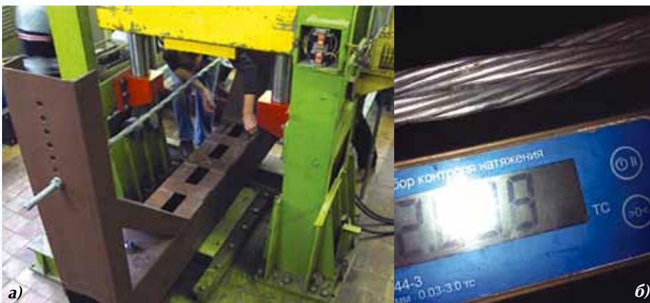
Рис. 4. Испытания троса на удар в лаборатории кафедры строительной механики МАДИ: а) вид стенда; б) измерение натяга
