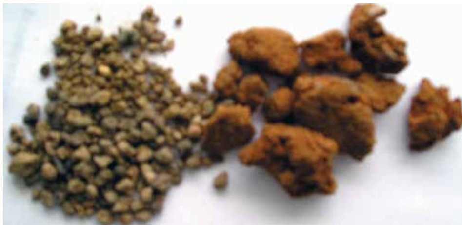
Рис. 1. Грунтовые агрегаты после измельчения супеси и суглинки при оптимальной влажности
