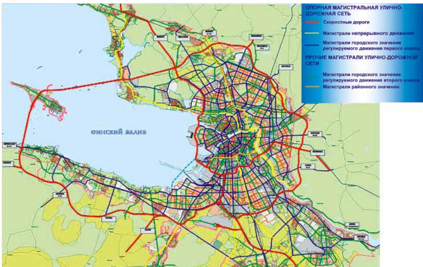
Рис 3. Проектная классификация улично-дорожной сети, принятая в отраслевой схеме развития УДС Санкт-Петербурга до 2015 года
