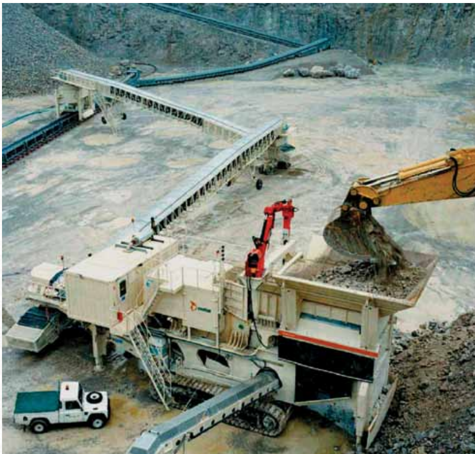
Рис. 4. Мобильный дробильный комплекс Lokotrack (Metso minerals) при циклично-поточной технологии
