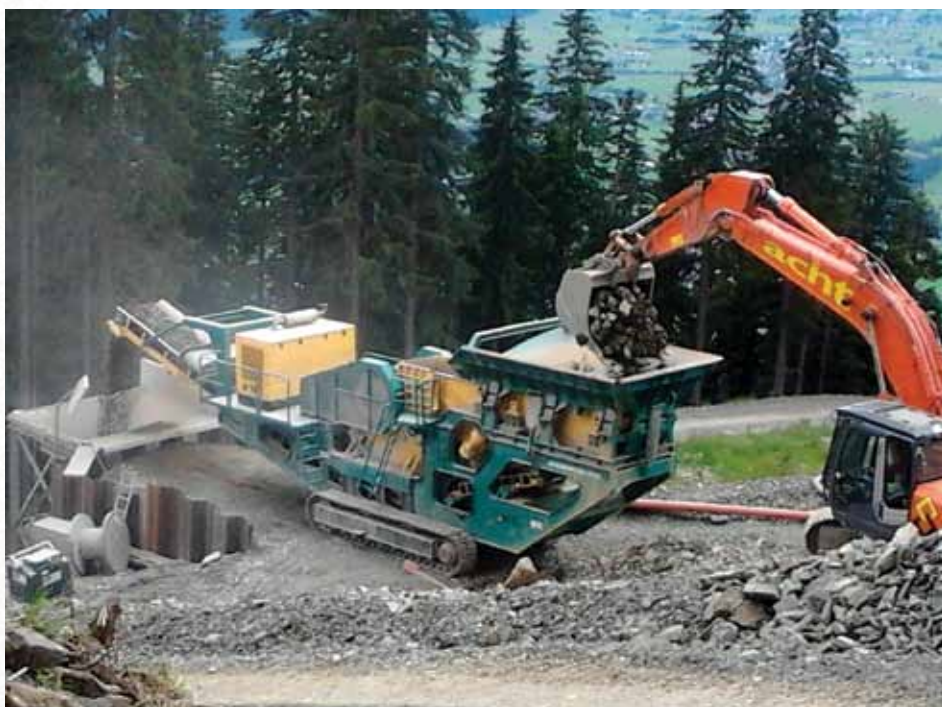
Рис. 1. Загрузка мобильной дробильной установки перед подачей горной массы на конвейер в карьере компании Strabag SE, Австрия (фото автора)
