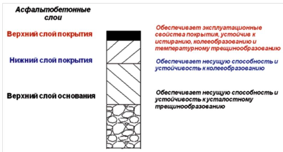
Рис. 2. Функциональное конструирование пакета асфальтобетонных слоев
