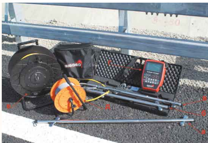
Рис. 3. Комплект оборудования для инклинометрических измерений: а) зона спиралеметра; б) пробный инклинометрический зонд; в) измерительный зонд инклинометра; г) регистратор данных; д) кабель пробного зонда; е) измерительный кабель инклинометра
