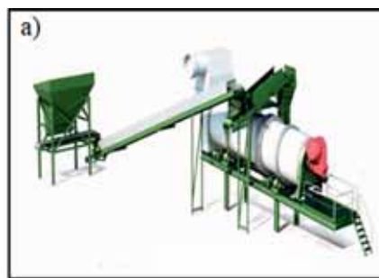
Принципиальная схема подачи гранулята в среднюю часть сушильного барабана АСУ
