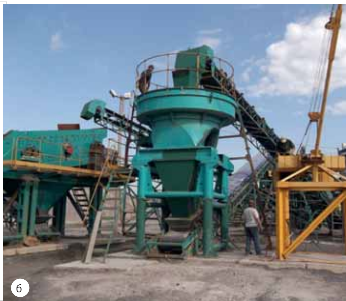
Рис. 4. Схема комплекса компании ДТМ (Россия) (а) на базе центробежно-ударной дробилки ЦУД-1600 (б): 1 – кабина управления; 2 – бункер-питатель вместимостью 10–15 куб. м; 3 – центробежно-ударная дробилка ЦУД-1600; 4 – грохот ГИС-62; 5 – грохот ГИС-53
