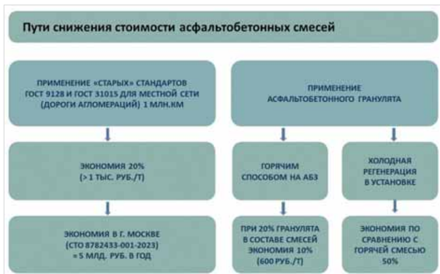
Рис. 1. Пути снижения стоимости асфальтобетонных смесей
