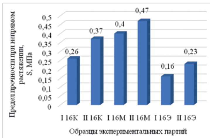
Рис. 8. Зависимость прочности от гранулометрического состава и вида вяжущего в АГБ
