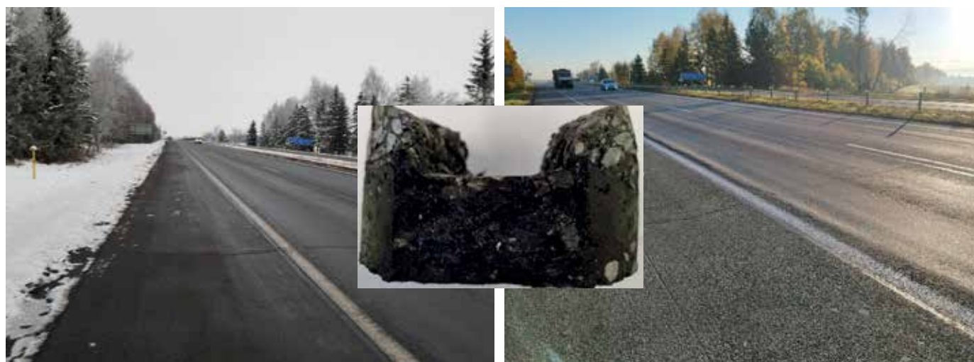
Рис. 4. Результаты испытания асфальтобетона и наблюдения за опытном участком с низкой колееустойчивостью
