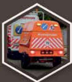
ИЗМЕРЕНИЕ ПРОЧНОСТИ ДОРОЖНЫХ ОДЕЖД «ДИНА-4 FWD»
