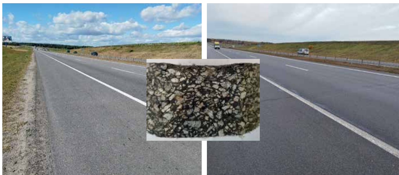
Рис. 5. Результаты испытания асфальтобетона и наблюдения за опытном участком с хорошей колееустойчивостью
