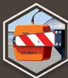
ГЕОРАДАРНОЕ ОБСЛЕДОВАНИЕ ДОРОЖНОЙ ОДЕЖДЫ
