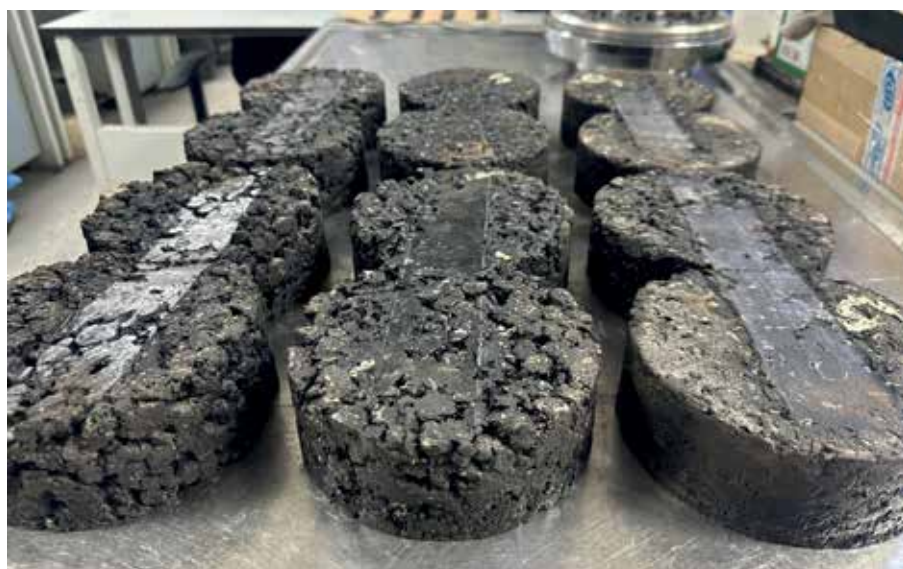
Рис. 4. Образцы SMA-16 после испытания на колееустойчивость в воде, слева направо – содержание пустот 6,1%; 3,3%; 2,0%
