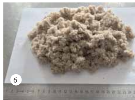
Рис. 3. Сравнение объема: а) гранулированная добавка 20 г; б) распушенное волокно 20 г
