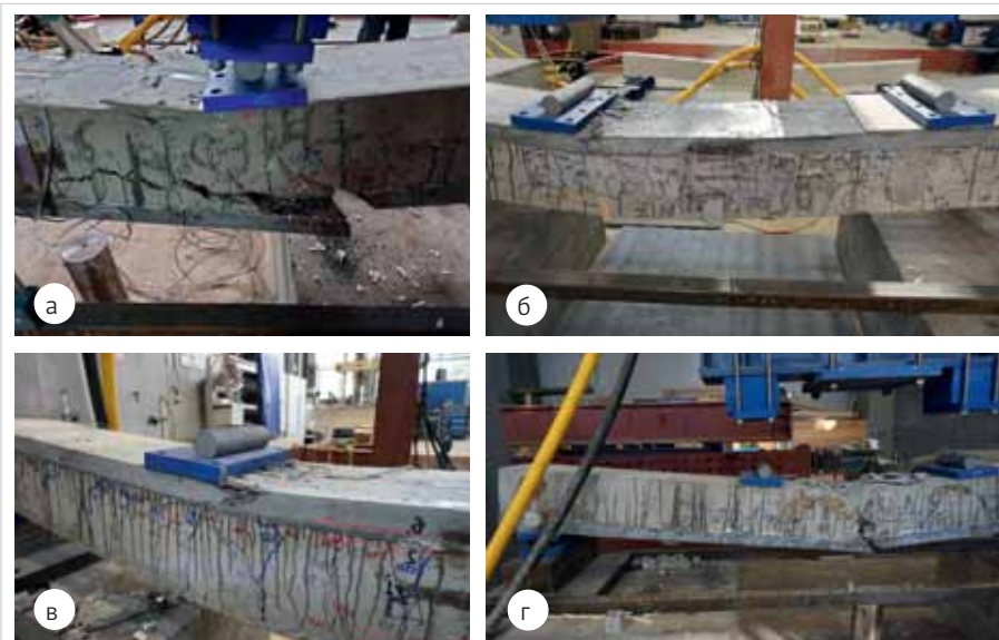
Рис. 3. Образцы 6 (а), 7 (б), 8 (в), 9 (г) после испытаний
