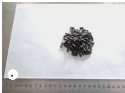
Рис. 3. Сравнение объема: а) гранулированная добавка 20 г; б) распушенное волокно 20 г
