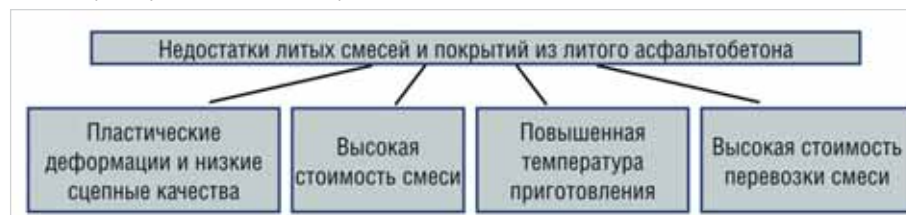
Рис. 2. Недостатки литых асфальтобетонных смесей
