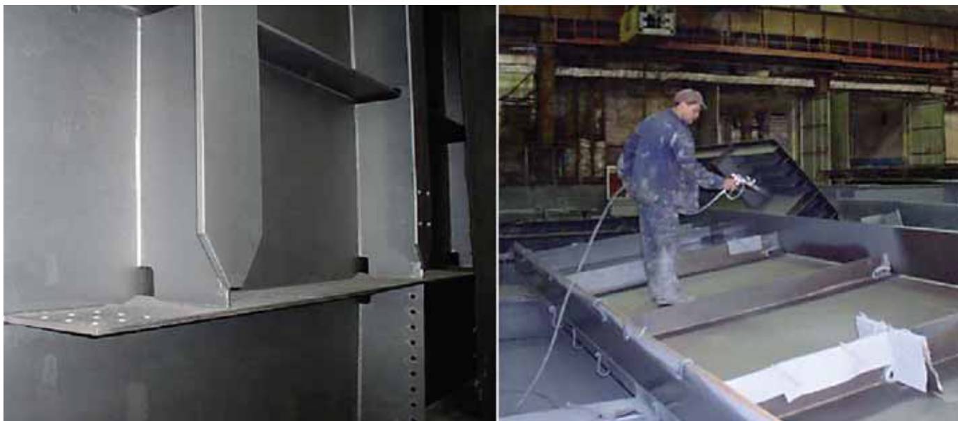
Заводская окраска мостовых металлоконструкций на заводе «Курганстальмост»
