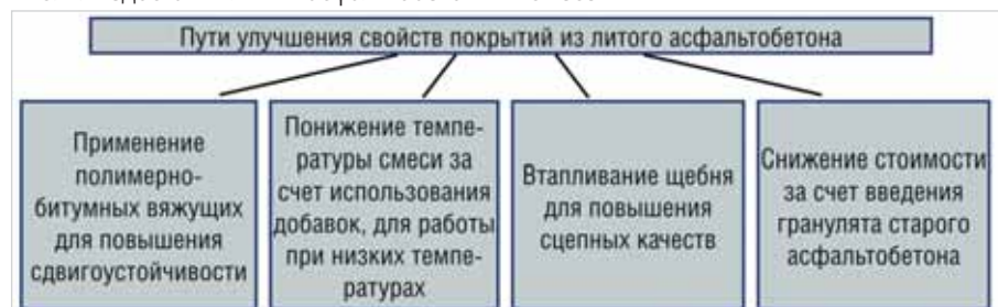
Рис. 3. Пути улучшения свойств покрытий из литого асфальтобетона
