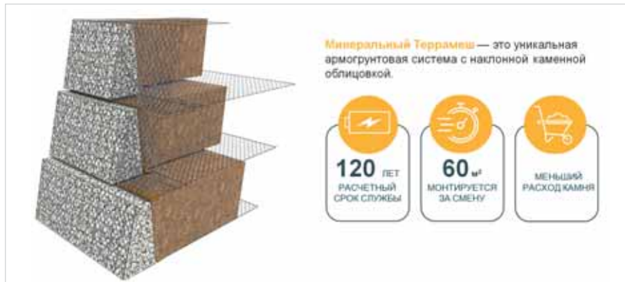
Схематичное изображение устройства армогрунтового сооружения на основе системы «Террамеш Минерал» и преимущества этой системы
