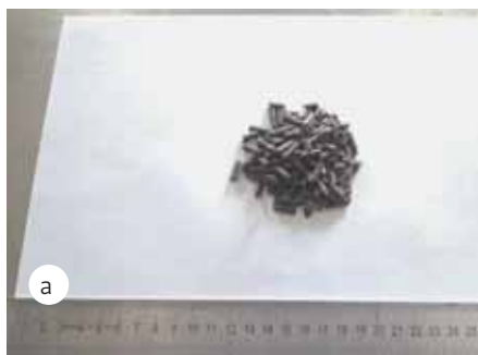
Фото 3. Сравнение объема: а) гранулированная добавка 20 г; б) распушенное волокно 20 г
