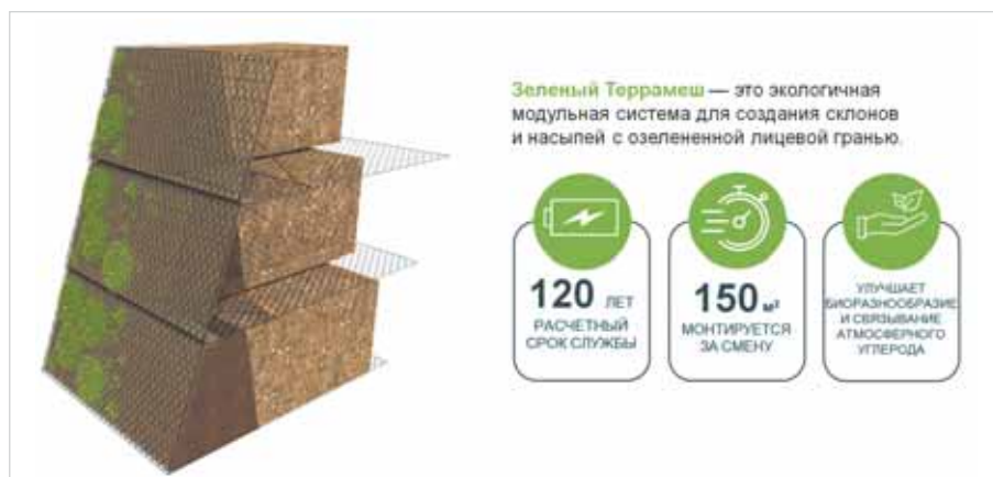
Схематичное изображение устройства армогрунтового сооружения на основе системы «Зеленый Террамеш» и преимущества этой системы
