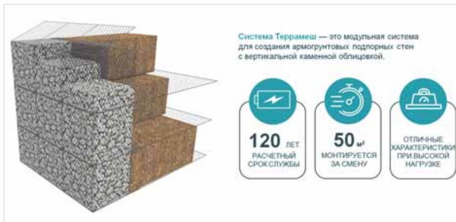
Схематичное изображение устройства армогрунтового сооружения на основе системы «Террамеш» и преимущества этой системы
