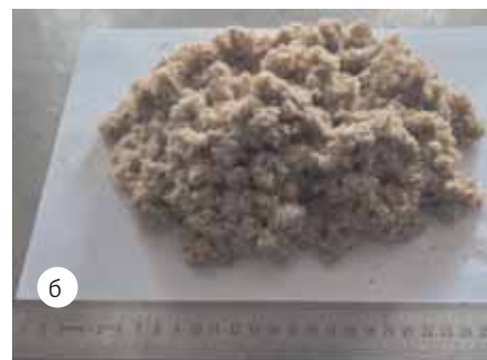
Фото 3. Сравнение объема: а) гранулированная добавка 20 г; б) распушенное волокно 20 г
