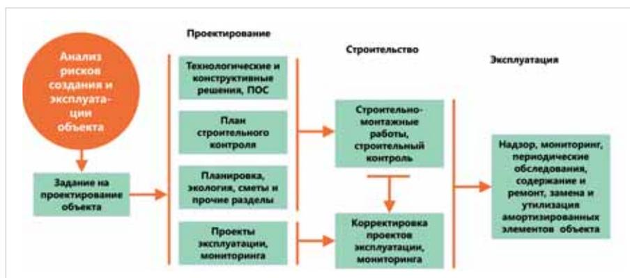
Рис. 3. Блок-схема «проактивной» организации жизненного цикла мостового сооружения, характерная для передовой мировой практики
