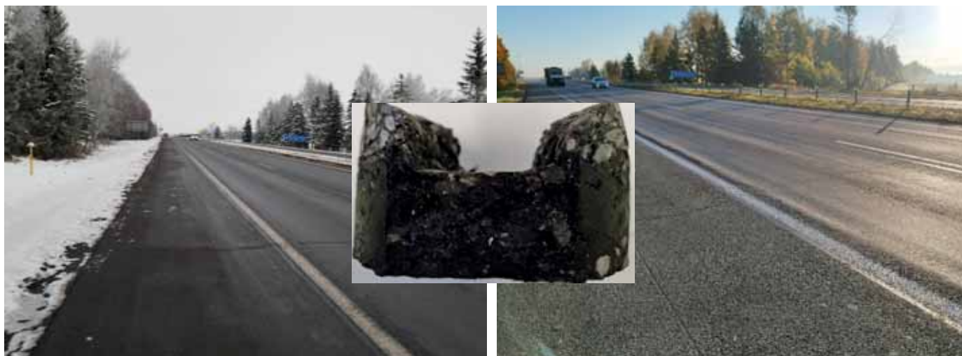
Рис. 4. Результаты испытания асфальтобетона и наблюдения за опытным участком с низкой колееустойчивостью
