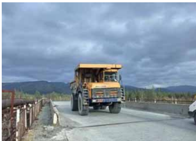
Рис. 3. Пропуск железнодорожной и автомобильной нагрузок по сооружениям промышленного предприятия. БелАЗ-7547 в загрузочном состоянии с давлением на заднюю ось 520 кН
