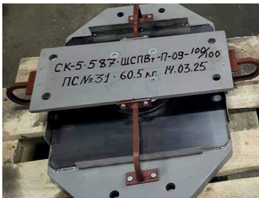
Рис. 4. Перевернутая опорная часть. Кожухи-зонтики отгружаются отдельно
