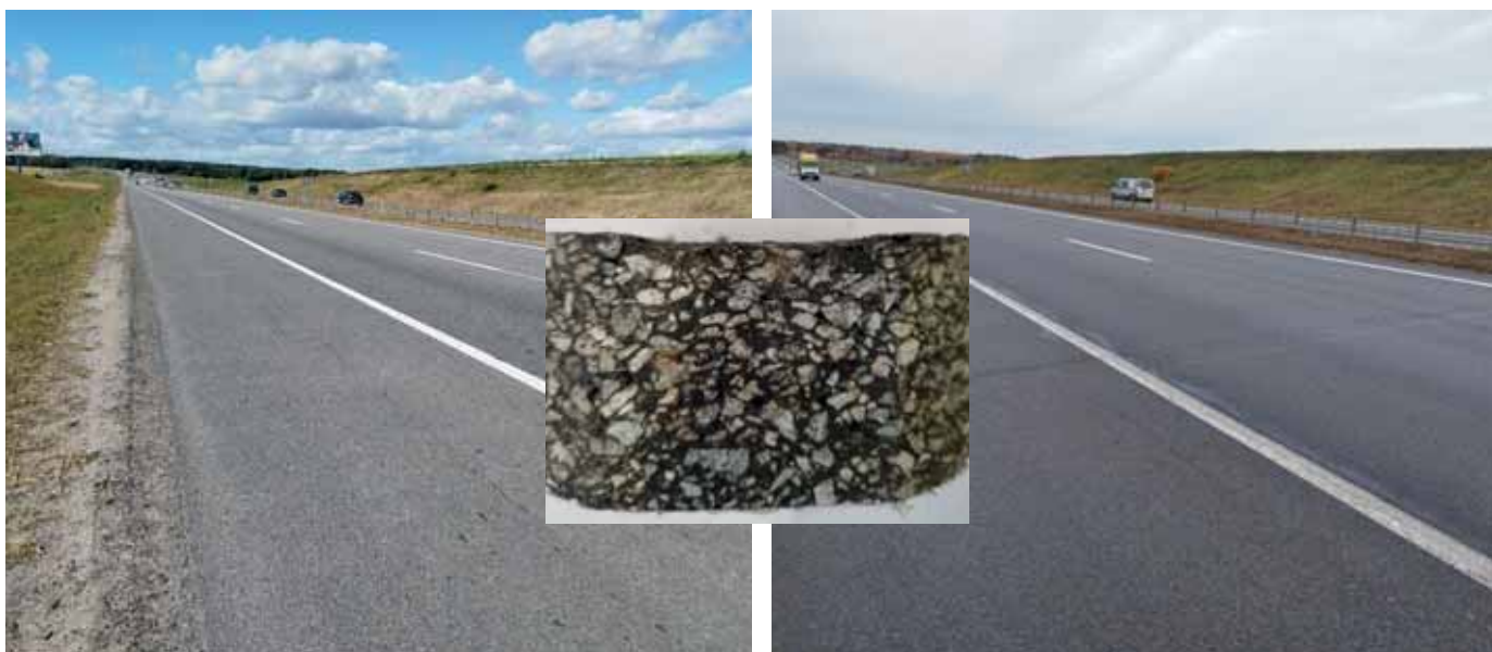
Рис. 5. Результаты испытания асфальтобетона и наблюдения за опытным участком с хорошей колееустойчивостью
