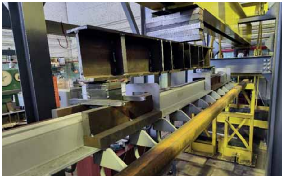
Рис. 5. Общий вид испытываемого деформационного шва на стенде
