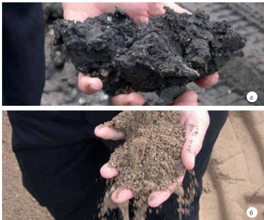
Глинистый грунт до обработки негашеной известью (а) и после (б)
