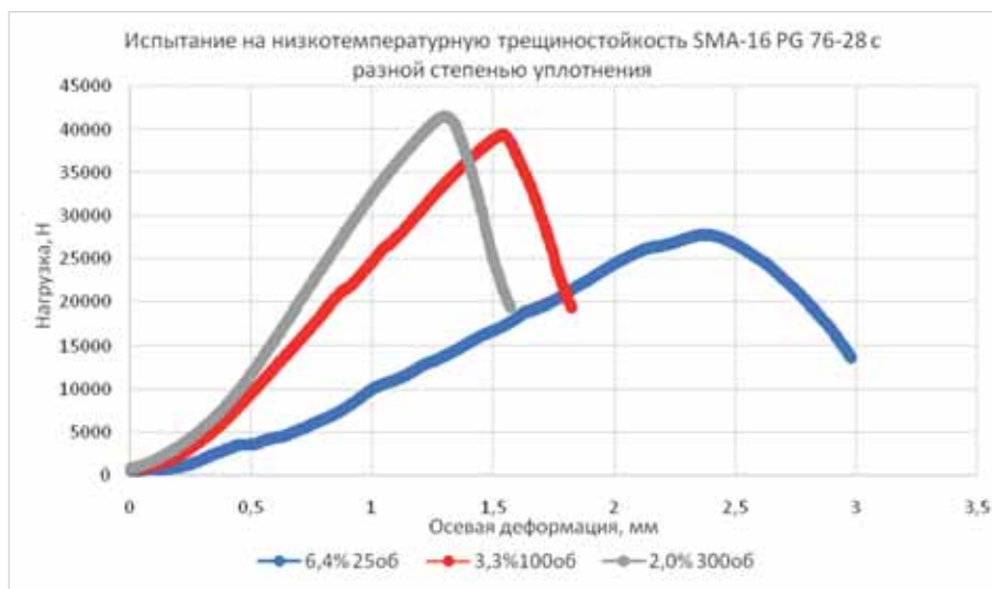
Рис. 6. Кривые испытания на низкотемпературную трещиностойкость образцов с разной степенью уплотнения
