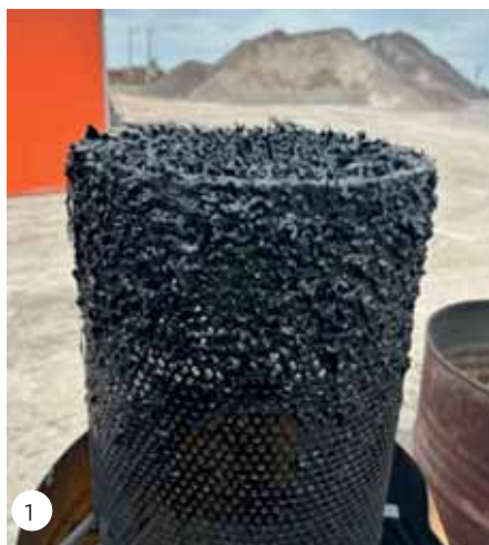
Битумный фильтр (рис. 1) и арбитражная проба (рис. 2) с одной из партий с определенным «пластификатором»
