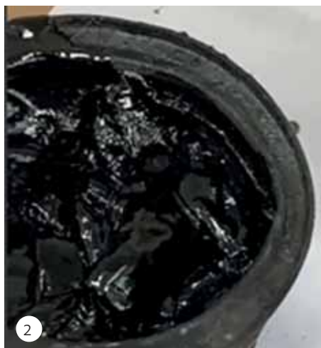
Битумный фильтр (рис. 1) и арбитражная проба (рис. 2) с одной из партий с определенным «пластификатором»
