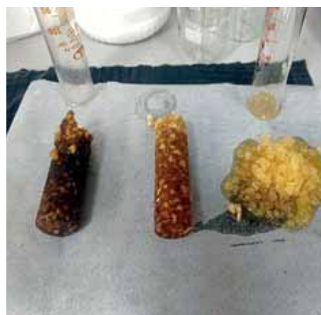
Рис. 4. Наглядный пример взаимодействия пластификатора и СБС-полимера в соотношении 25% СБС на 75% пластификатора
