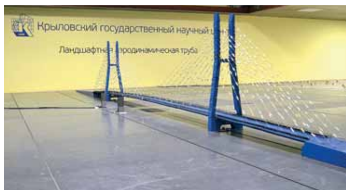
Рис. 3. Полная динамическая модель моста в рабочей части Ландшафтной аэродинамической трубы
