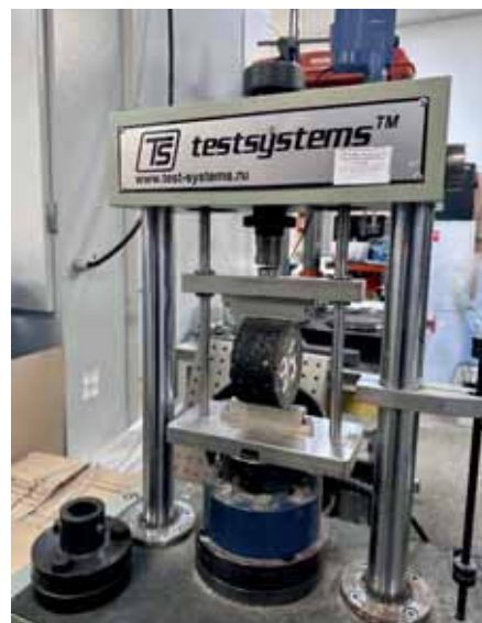
Рис. 5. Оборудование по испытанию на низкотемпературную трещиностойкость при непрямом растяжении
