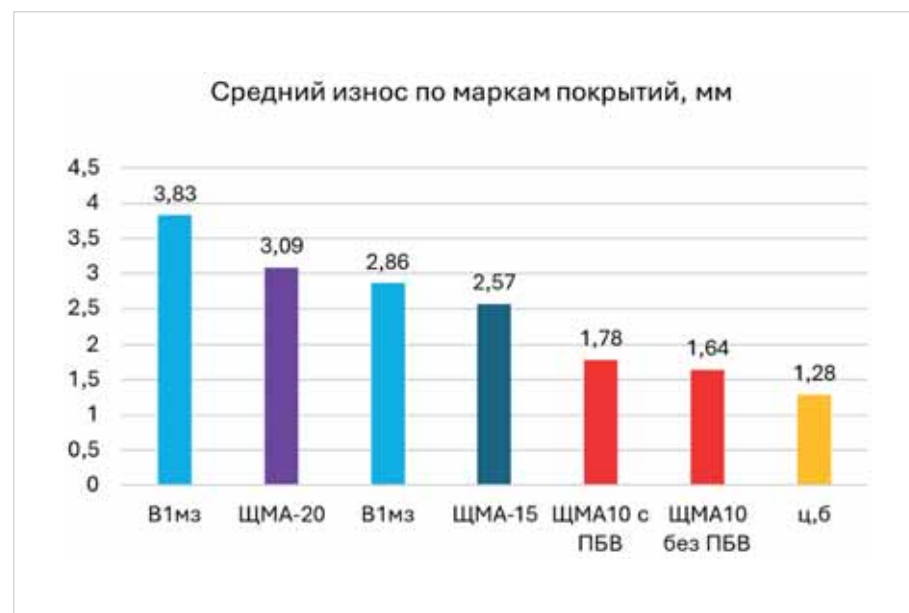
Рис. 3. Результаты замеров износа (глубины колеи) после серии испытаний (этап I)
