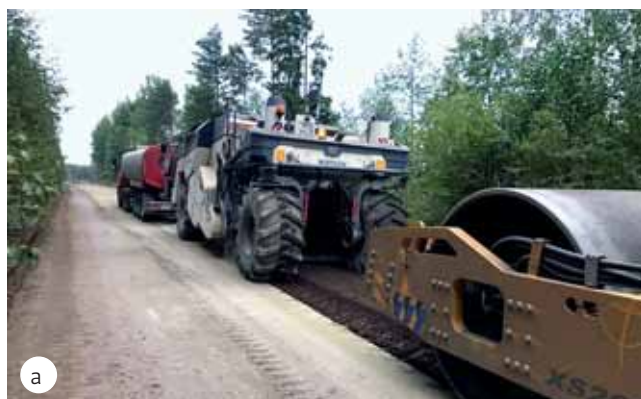
Рис. 1. Методы технологии холодного ресайклинга: а – холодный ресайклинг на месте (ХРМ); б – холодный ресайклинг с применением стационарных смесительных установок (ХРУ) [6]
