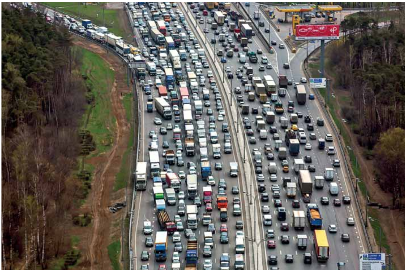
Рис. 2. Турбулентное движение на правых полосах движения и ламинарное (параллельно-струйное) на левых полосах основного (сквозного) направления в зоне въезда на автомагистраль; ламинарное (параллельно-струйное) в зоне съезда с автомагистрали. Плотное насыщенное состояние транспортного потока. Турбулентное состояние потока на въезде на автомагистраль (однопольный въезд, плотно насыщенное состояние потока)
