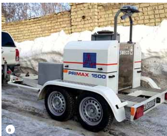
Рис. 1. Современные установки ударного нагружения FWD (а – установка ударного нагружения FWD-RDT, б – установка ударного нагружения Дина – 4 (FWD Dynatest), в – установка ударного нагружения FWD PRIMAX, г – установка ударного нагружения FWD Dynatest)
