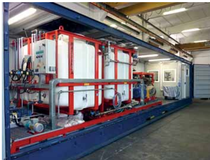
Рис. 2. Размещение битумно-эмульсионных установок компании в 20-футовом контейнере
