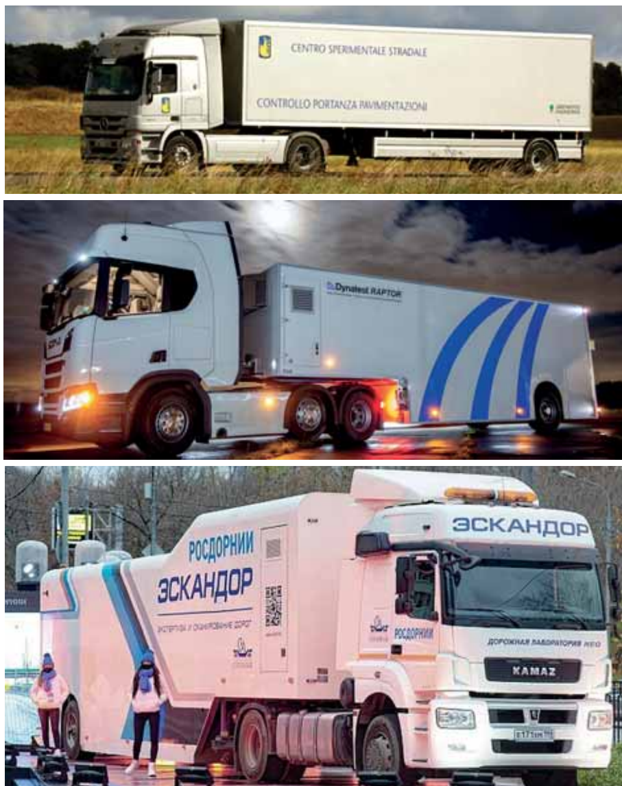
Рис. 4. Установки динамического нагружения с движущимся колесом
