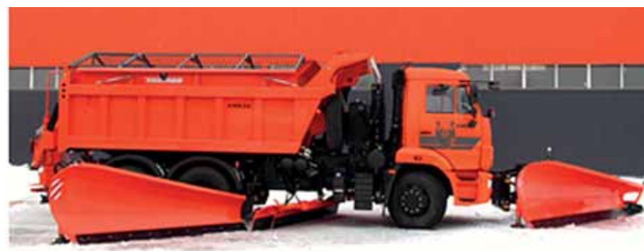
Новый магистральный отвал с подвижным креплением ножей серии «ВЕЛЕС» рабочей шириной 3600, 3900 и 4200 мм
