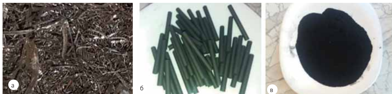
Рис. 4. Компоненты асфальтобетонной смеси: а) стальная фибра 0,7-1,0 см, диаметр 0,1 мм; б) графитовые стержни; в) графитовый порошок [3]
