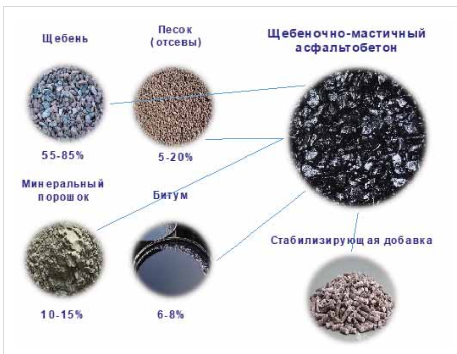
Рис. 1. Традиционный состав щебеночно-мастичного асфальтобетона
