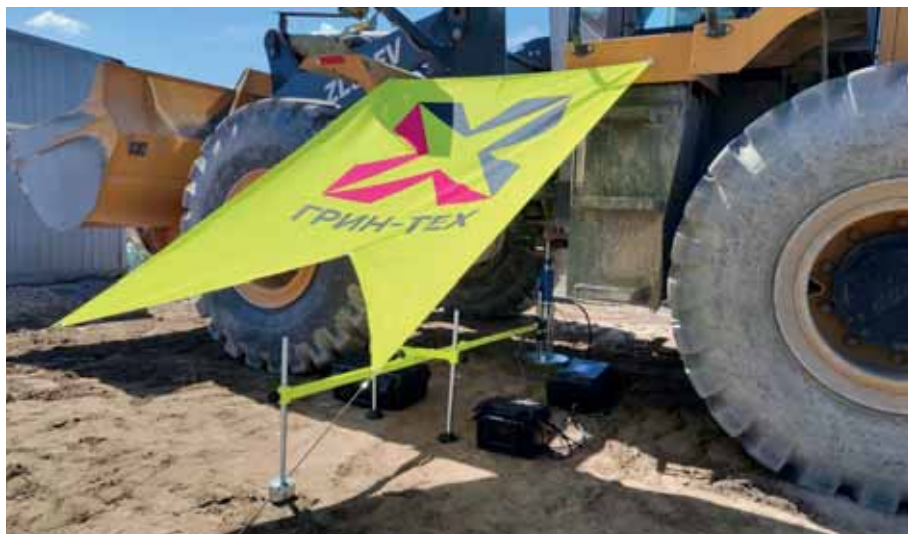
Комплекс определения деформационных характеристик «УПОР-1» На тестовой площадке АлтайАвтодор
