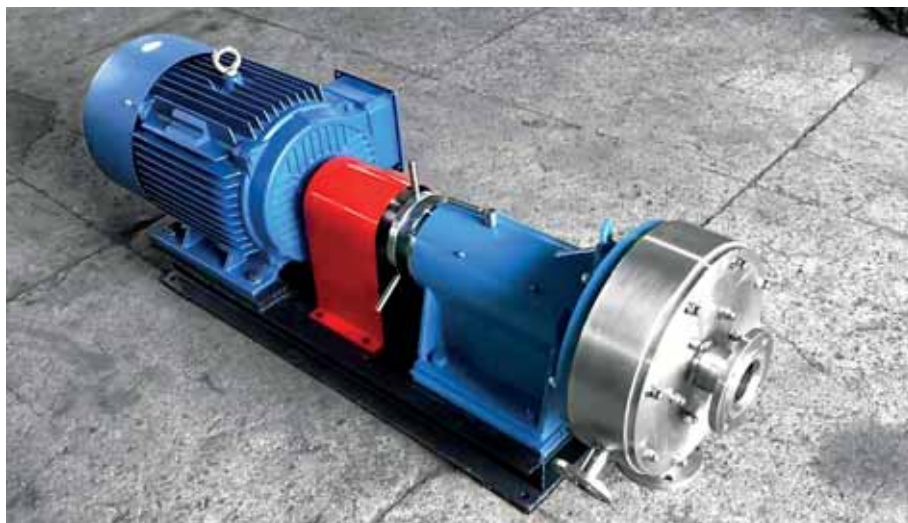
Рис. 4. Высокооборотистая коллоидная мельница компании Solomatic (Россия)
