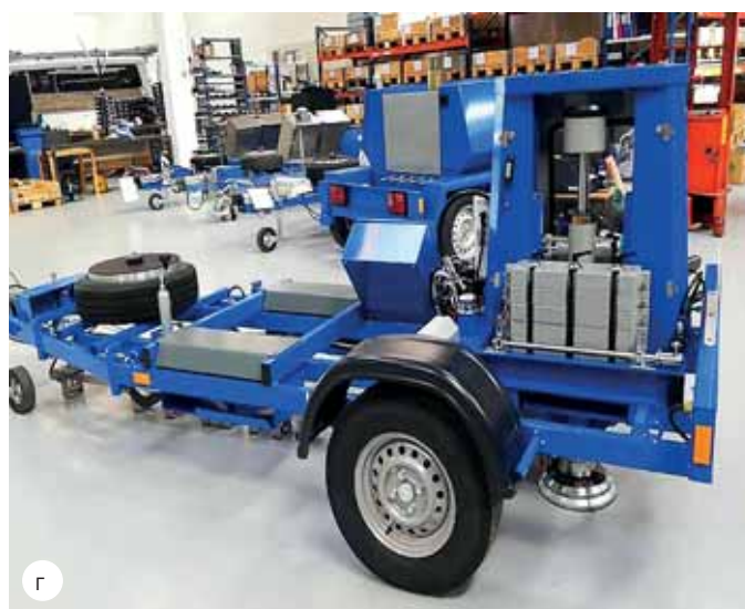
Рис. 1. Современные установки ударного нагружения FWD (а – установка ударного нагружения FWD-RDT, б – установка ударного нагружения Дина – 4 (FWD Dynatest), в – установка ударного нагружения FWD PRIMAX, г – установка ударного нагружения FWD Dynatest)
