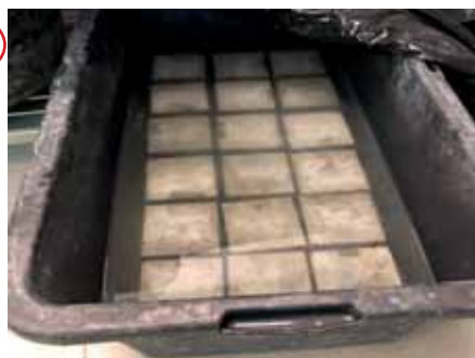
Рис. 5. Насыщение бетонных образцов в 5% растворе хлорида натрия
