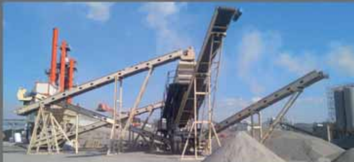
Поволжье. Транспортабельная установка дробления для производства кубовидного щебня 4 узких фракций
