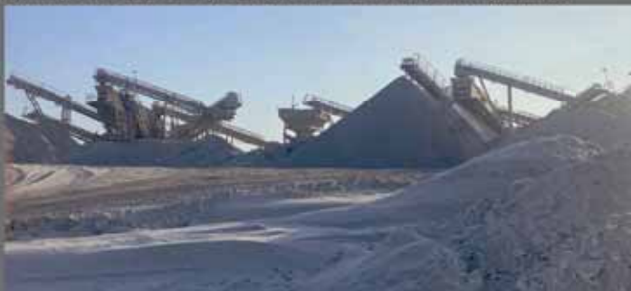
Сибирь. 3-стадийная транспортабельная установка для производства кубовидного щебня 6 узких фракций
