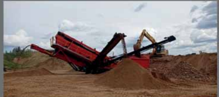
Центр. Гусеничная сортировочная установка для производства песка и 4 фракций гравия
