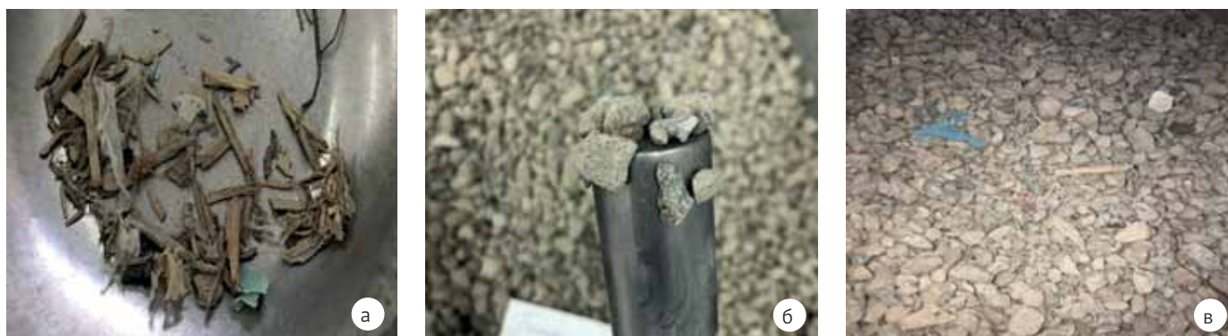
Рис. 3. Визуально детектируемые особенности вторичного щебня: а) отделенные от вторичного щебня щепа, картон, металл, пластик, б) в составе частиц, вторичного щебня присутствуют неотделяемые металлические включения, выявляемые магнитом, в) неотделяемые при просеве остатки металла, дерева, кирпича
